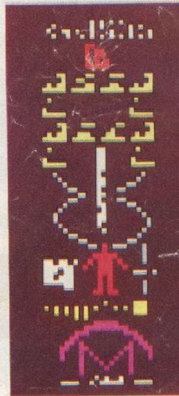
Mensaje de 1679 bits enviado desde Arecibo hacia el cúmulo M13, a 25.000 años luz de la Tierra
