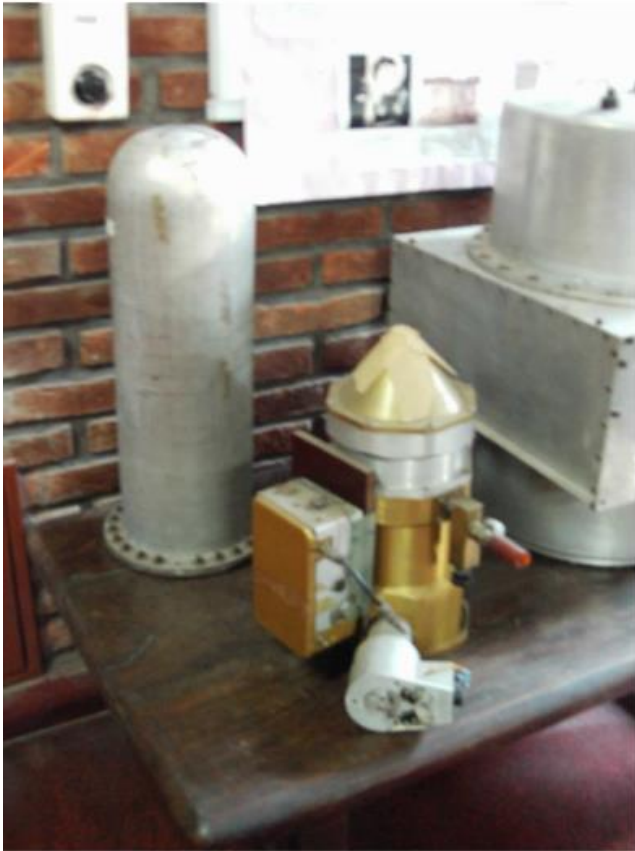
Adelante: el bolómetro de Galio-Germanio del proyecto ALIR. Detrás a la izquierda: detector de rayos X. Museo del IAFE.
