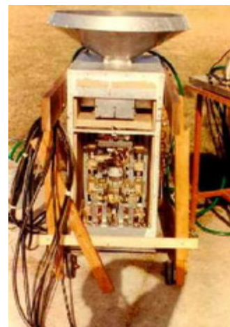
Cabezal del receptor de la Antena II – IAR
