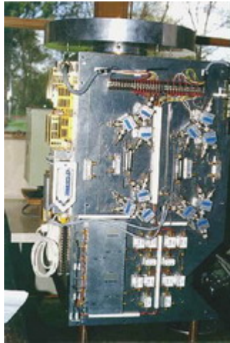
Actual Cabezal del receptor de la Antena I – IAR
